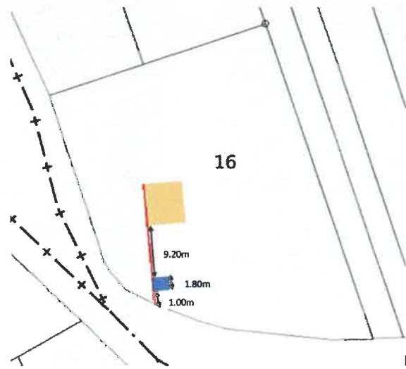
■ Emplacement de la dalle sur laquelle seront placés les distributeurs de pizzas et boissons Dimension de la dalle : 2,75x1,80m.
