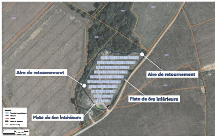
Plans de masse du projet de centrale photovoltaïque « Les Genièvres » à Charenton-du-Cher fournis par le porteur de projet.
